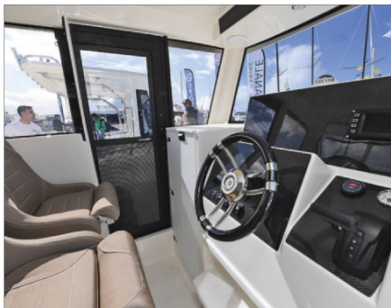
L'importante surface vitrée dans la timonerie garantit au pilote une bonne visibilité sur 360 degrés. Deux portes latérales coulissantes assurent l'accès à l'habitacle.
