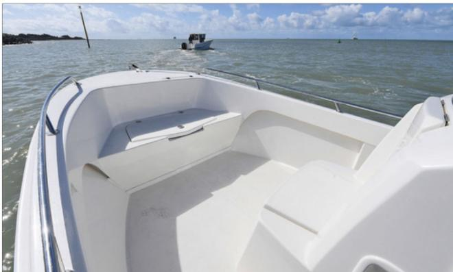
L'espace à l'avant est complètement dégagé, avec seulement un coffre positionné dans le prolongement de la baïlle à mouillage.
