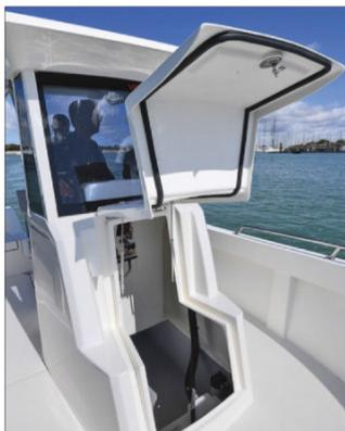
L'accès à l'intérieur de la console se fait par une porte située à l'avant et montée sur vérons.
